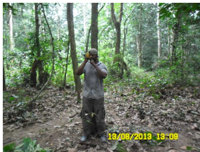
Photo : utilisation d'un télémètre pour évaluer la distance comprise entre un arbre et un axe.
